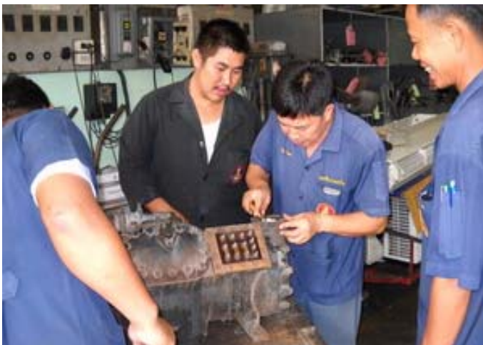
ช่อมคอมเพรสเซอร์ ขนาด ๒๐HP ติดตั้งที่ กองการกำลังพล กพ.ทร.
